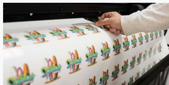
■ HP Latex打印及裁切方案為每份打印作業生成獨立條碼，由裁切機自動識別該作業設定。
